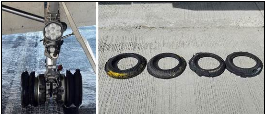
Figura 7. Daños en los neumáticos
