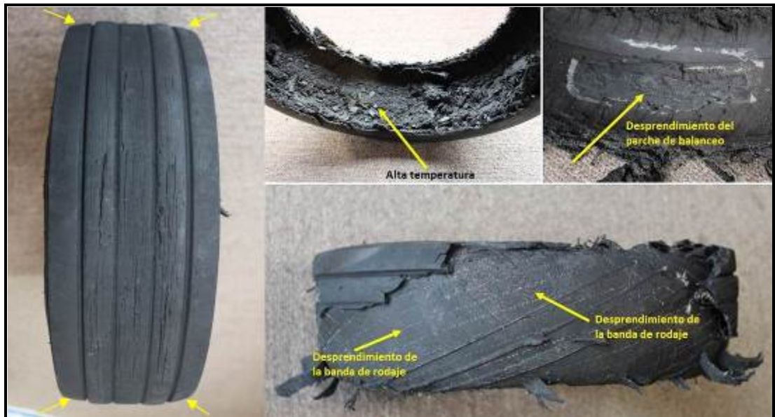
Figura17. Desgaste y daños en las cubiertas
