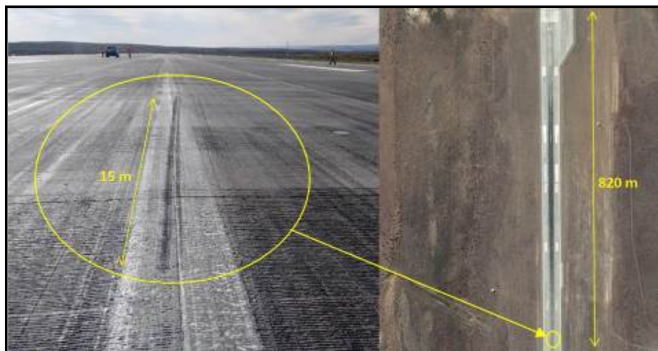
Figura 5. Marcas dejadas por la rotura de los neumáticos
