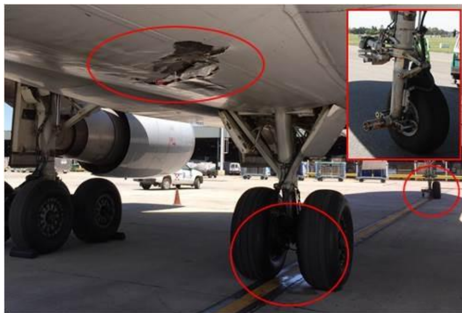
Figura 1. Vista general de la rueda faltante y de los daños sufridos
