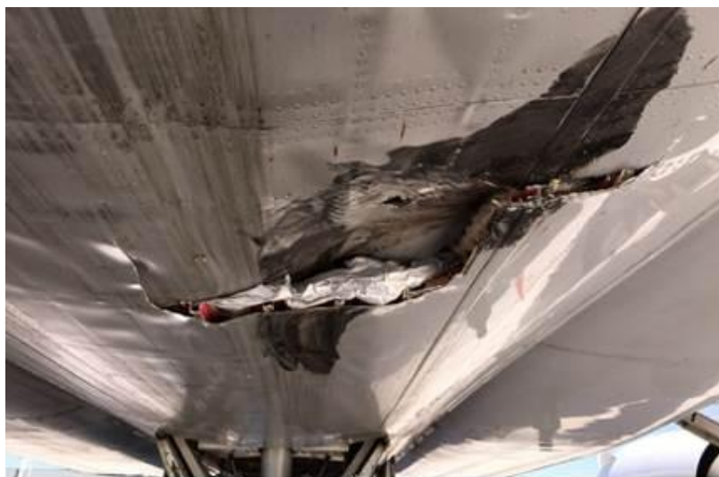
Figura 6. Imagen de daños sufridos en estaciones STA 5-53000, STA 15 61000 y L51LH, L48RH
