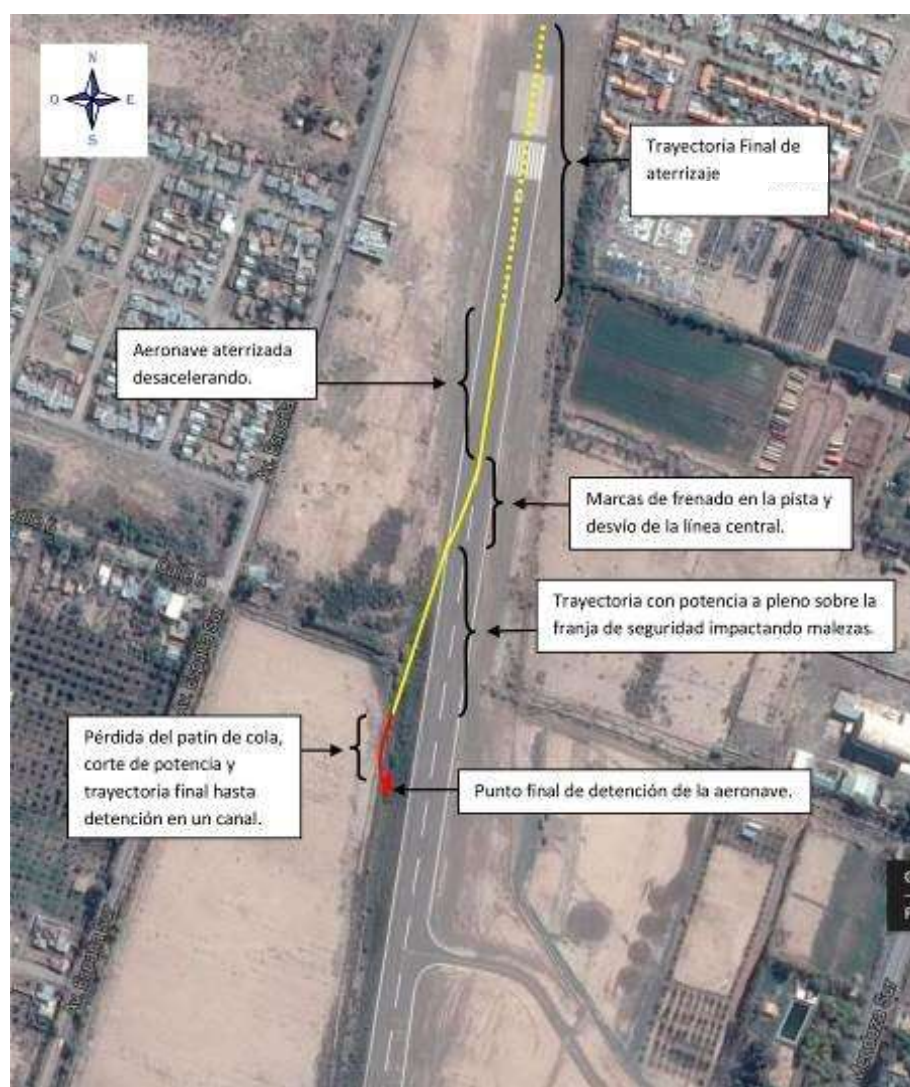
Figura 7. Descripción de la trayectoria de la aeronave en la excursión de pista
