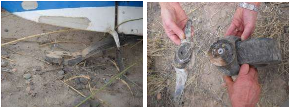
Figura 4. Daños en el tren de cola
