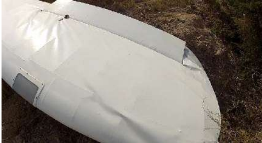
Figura 3. Vista de daños del ala izquierda
