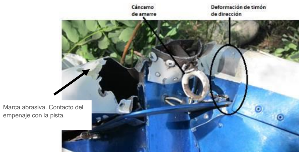
Fig. 5: Interferencia del cáncamo en el movimiento del timón de dirección - Marcas abrasivas del tail strike
