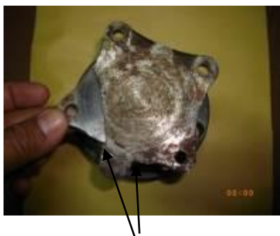
Zona de comienzo de fisura y ángulos vivos
