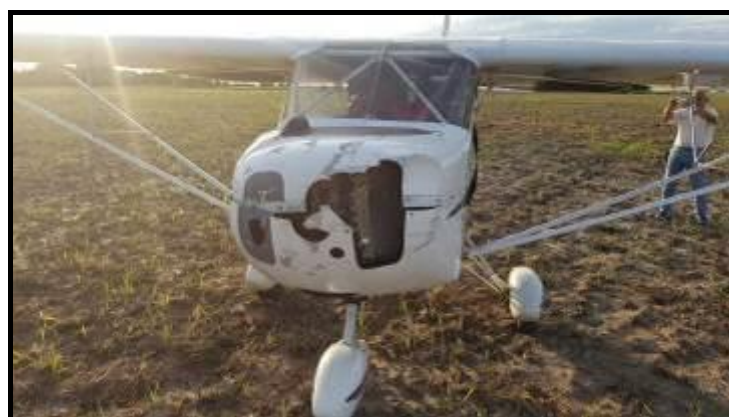
Fig. 3: Detalle de roturas en el capot del motor.
