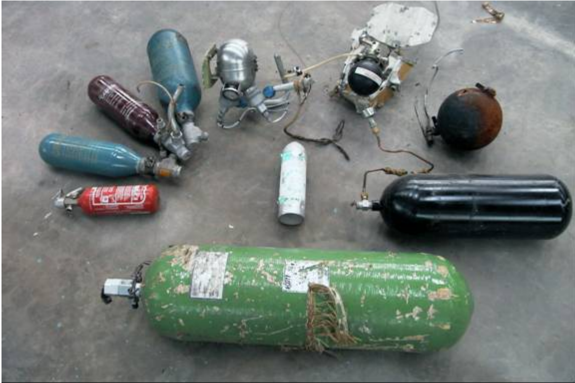
Figura 1. Muestra de contenedores de presión recuperados de accidentes de aviación
