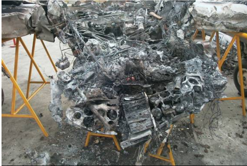
Figura 2. Daños por incendio al puesto de pilotaje y aviónica
